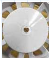
モーター軸とプロペラは半月型になっており 取付方向があります。
